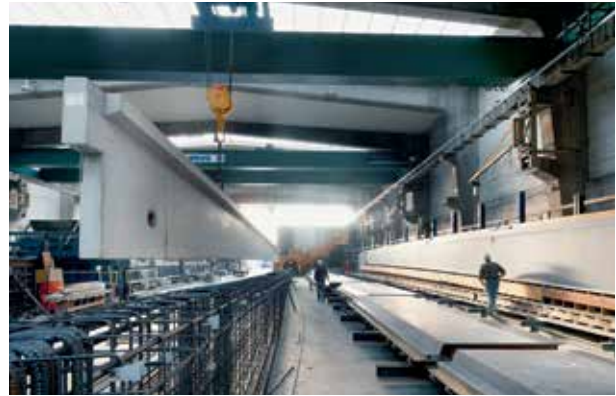
Produktion individueller Stahlbetonfertigteile im Werk.
